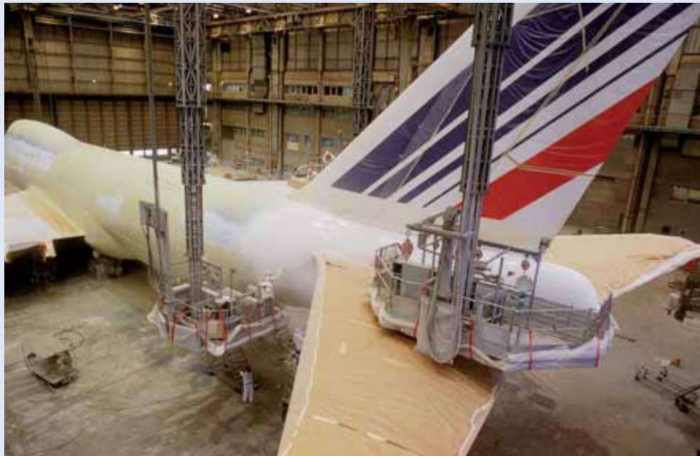
Dans des passerelles télescopiques, des peintres traitent la dérive et le fuselage
